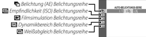
Wenn das **DRIVE**-Einstellrad auf **BKT1** oder **BKT2** gedreht wird, zeigt das Drücken der Taste die Optionen für die Belichtungsreihen an (📖 65). Drücken Sie die Auswahltaste nach oben oder unten, um einen Belichtungsreihentyp auszuwählen; wenn der Zugriff möglich ist, können Sie mit der Auswahltaste nach links oder rechts die Belichtungsstärke auswählen.
